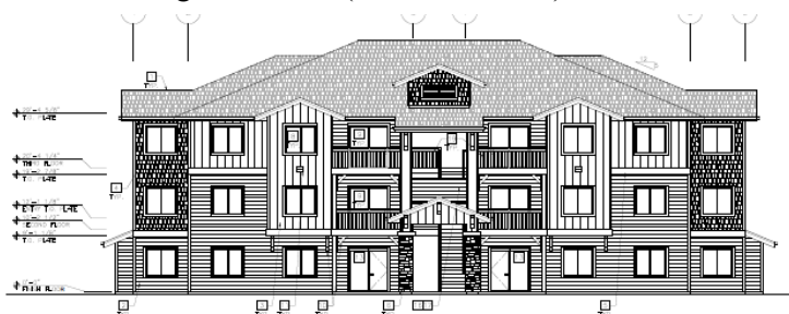
FRONT ELEVATION SCALE: 1/8" = 1'-0"
